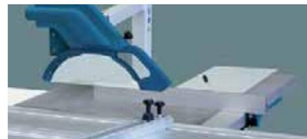
Электромеханическое управление параллельного упора
