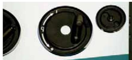
Настройка параметров параллельного упора с помощью маховиков грубой и тонкой подстройки
