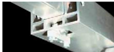
Выдвижной элемент телескопического попер.упора. Оснащен подшипниками скольжения
