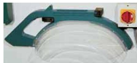
Крепление защитного кожуха на корпусе станка
