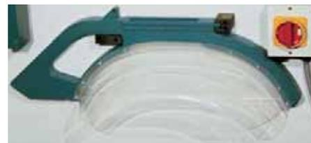
Крепление защитного кожуха на корпусе станка
