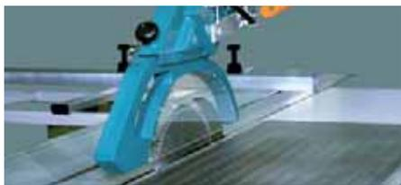
Узкий вытяжной защитный кожух
