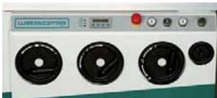
Фронтальное управление: настройка по высоте, углу наклона, настройка параллельного упора
