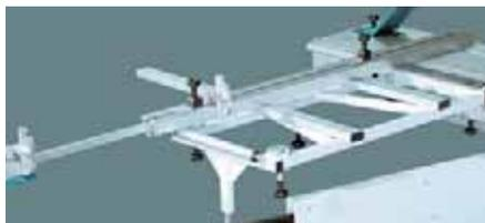
Поперечный упор с функцией удлинения до 3250 мм
