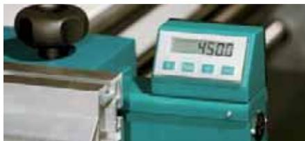
Электронный дисплей параллельного упора
