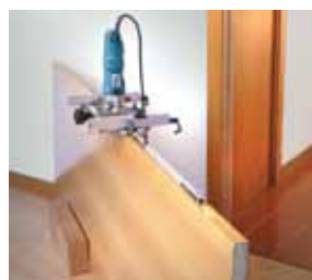
Для производства других работ на дверях и рамах нет необходимости заново настраивать устройство..
