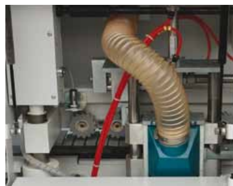
Узел прифуговки с эффективной системой пылеудаления обеспечивает чистоту и ровность поверхности заготовки перед нанесением клея.
