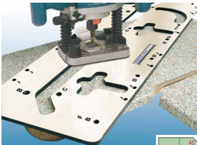
Фрезерование крестообразного паза на обеих столешницах под стяжки.
