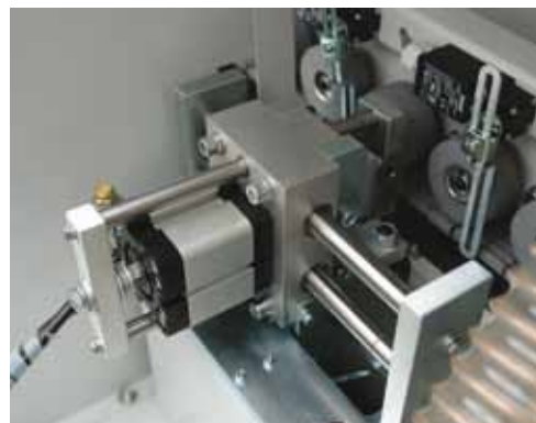
Мощный двухсторонний пневматический торцовочный узел.
