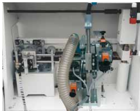
Торцевой подрезатель и комбинированный фрезерный узел.
