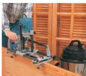
Возможность установки фрезера в горизонтальном положении.
