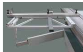
Поперечный поддерживающий стол с телескопическим упором
