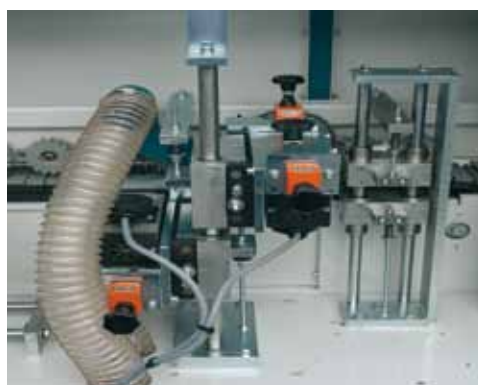
Комбинированный фрезерный узел и узел прямой циклевки обеспечивают отличное качество поверхности заготовки.
