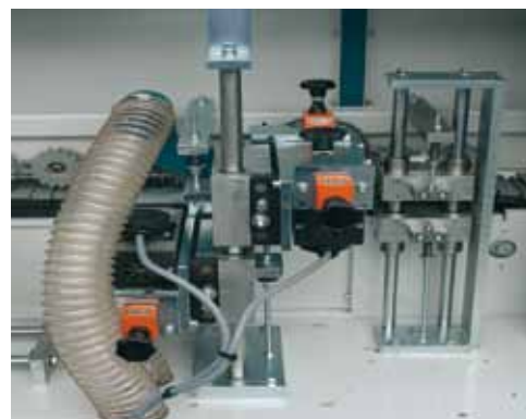
Комбинированный фрезерный узел и узел прямой циклевки обеспечивают отличное качество поверхности заготовки.
