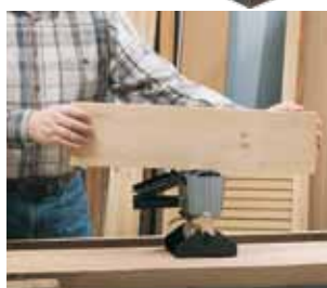
Модели EM125T и EM25D оснащены верхним валиком.
