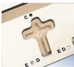
Фрезерование крестообразного паза на обеих столешницах под стяжки.
