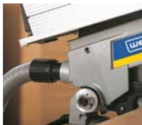
Оснащена адаптером для подключения пылеудалющего аппарата
