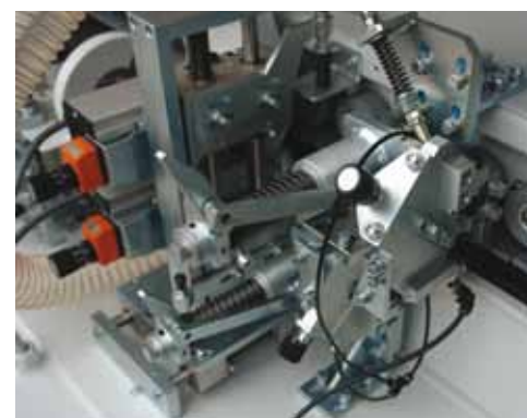
Узел радиусной циклевки облагораживает поверхность заготовки на радиусе кромки.
