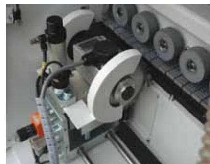
Торцовочный узел с электронной системой управления SPS.
