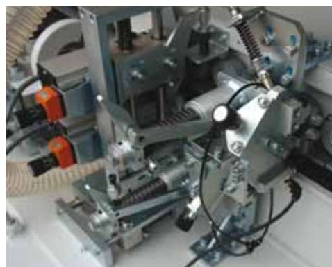
Узел радиусной циклевки облагораживает поверхность заготовки на радиусе кромки.
