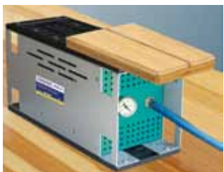
Возможность крепления маленьких заготовок благодаря разделенной поверхности держателя.
