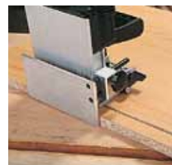
Формирование паза с помощью бокового упора.
