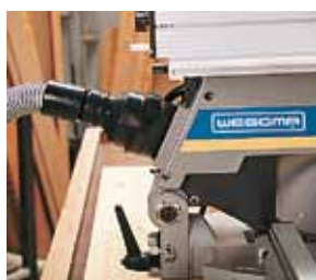
Оснащена адаптером для подключения пылеудалющего аппарата
