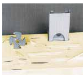
Фреза для устранения дефектов древесины (смоляные карманы, сучки и т.д.)
