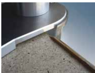
Одновременная обработка заготовки по радиусу кромки и заподлицо.
