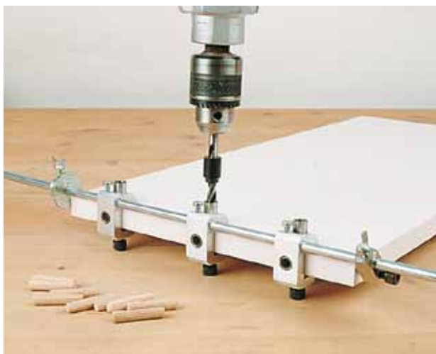
Позволяет производить сверление в плась и в торец.
