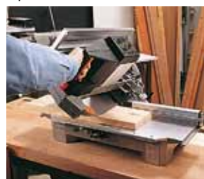
Голова пилы наклоняется на угол от 0° до 45°
