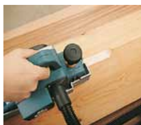
FH71 с подсоединением к пылеудалняющему аппарату. (доп. комплектация).
