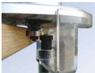
Адаптер для пылеудаления с системой торможения подшипника.
