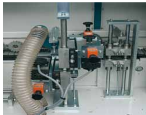
Комбинированный фрезерный узел и узел прямой циклёвки обеспечивают отличное качество поверхности заготовки.
