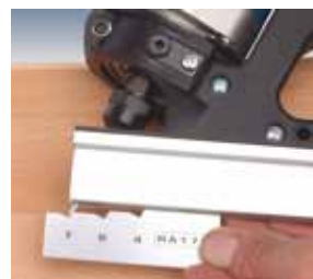
Идеально точная установка глубины фрезерования.
