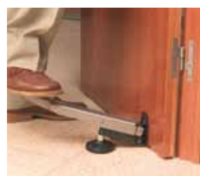
Легкий и быстрый монтаж деревянных и железных дверей и других тяжелых конструкций
