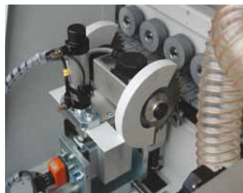
Торцовочный узел с электронной системой управления SPS.
