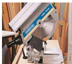
Защиту против случайного опускания пильного диска и случайного запуска обеспечивает прерыватель подачи тока
