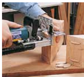
Поворотный упор позволяет выполнять регулировку по высоте и углу (высота 50 мм).
