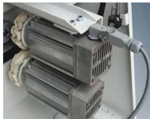
Полировочный узел для финишной обработки.
