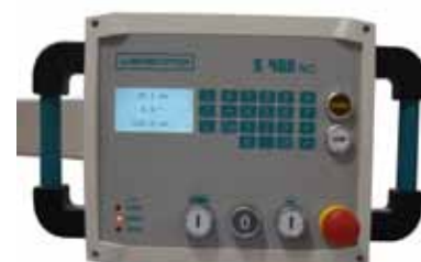
Панель управления станка S400NC.
