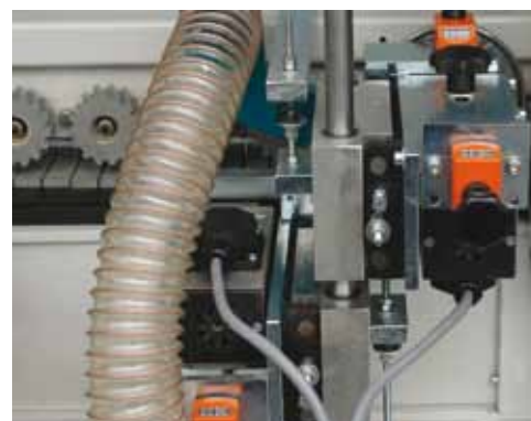
Фрезерный узел оснащен цифровыми счетчиками.
