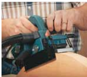
Строгание выгнутой поверхности.
