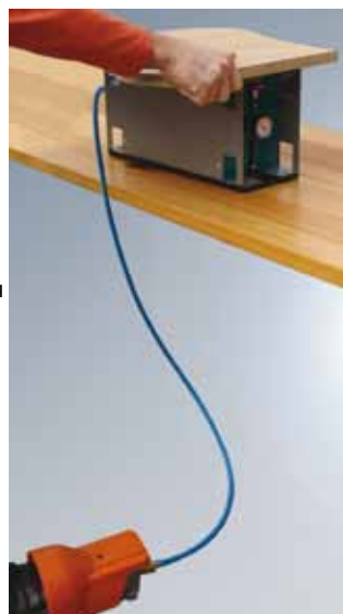
Педаль - выключатель значительно упрощает работу.
