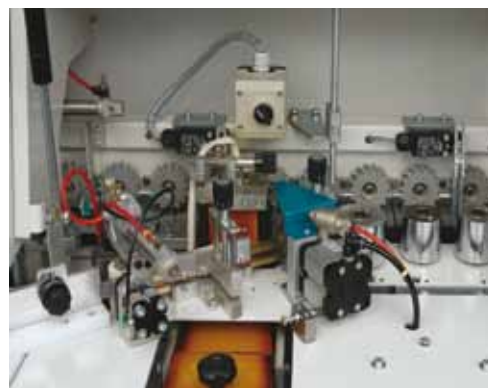
Клеевая ванна с механизмом отвода, гильотина, три индивидуально настраиваемых стальных прижимных ролика.
