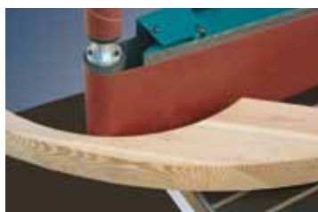
Шлифование на натяжном валке ленты.
