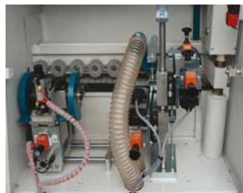
Торцовочный узел с электронной системой управления SPS и комбинированный фрезерный узел (верхний и нижний).
