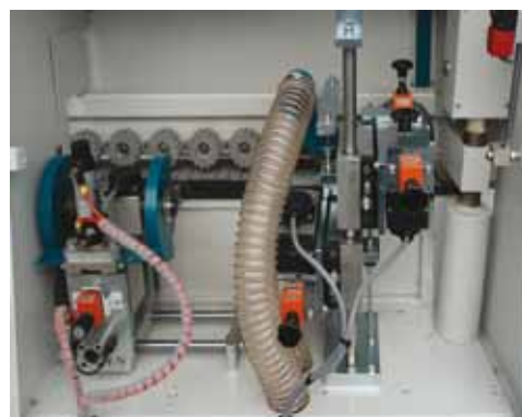
Торцовочный узел с электронной системой управления SPS и комбинированный фрезерный узел (верхний и нижний).
