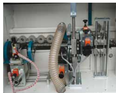
Торцовочный узел с электронной системой управления SPS, комбинированный фрезерный узел и узел прямой циклевки (опция).
