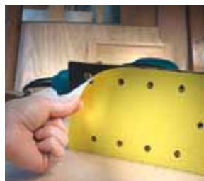
Использование самофиксирующихся (velcro) абразивных материалов
