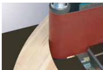
Шлифование с помощью натяжного вала ленты или устройства для обработки закругленных заготовок.
