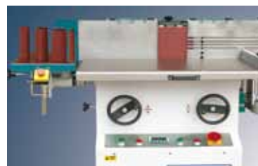
В любое время возможно переоборудование в шлифовальный станок для обработки шпона.
