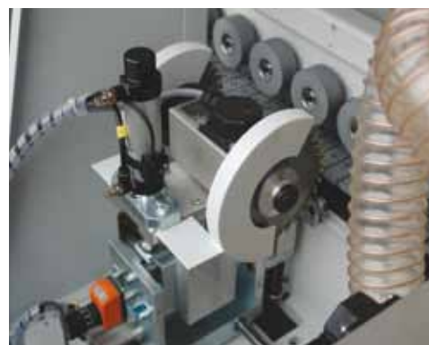
Торцовочный узел с электронной системой управления SPS.
